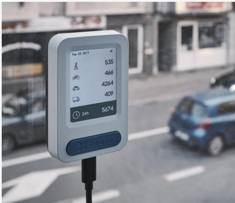
Telraam est une solution **alimentée par les citoyens** permettant de collecter des données multimodales sur le trafic à l'aide d'un appareil **abordable** et **facile à utiliser**.
